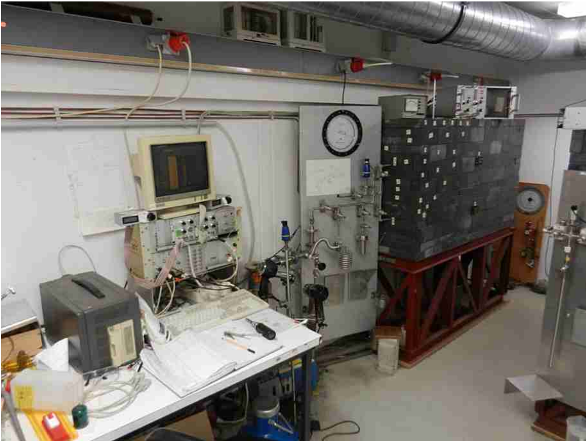
Abbildung 4.8: Der Tritiummessstand im Keller des IUP. Von links: Datenerfassung und Verarbeitung, Probeneinlass, Bleiabschirmung der Proportionalzählrohre und Hochspannungsversorgung.
