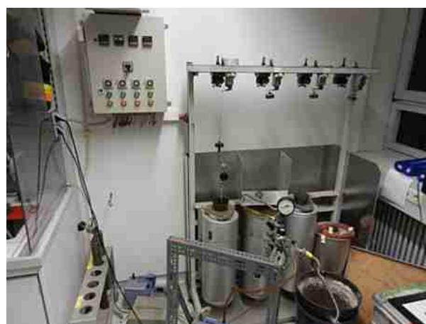
(d) Ofenstand zum Zersetzen der Proben
