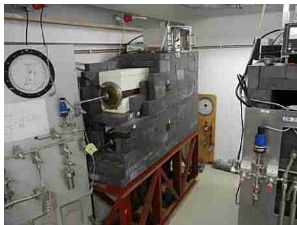
(b) der Tritiumzählrohrstand mit teilweise entfernter Bleiabschirmung
