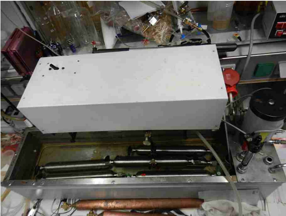
Abbildung 4.12: Der Rüttler mit Wasserbad zum Temperieren der Proben.
